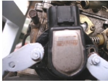
Hình 3.5 Cam bi n vị trí bơm ga động cơ Toyota và vị trí lắp đặt cam bi n - Lắp đặt cam bi n nhiệt khí nạp lên động cơ .
