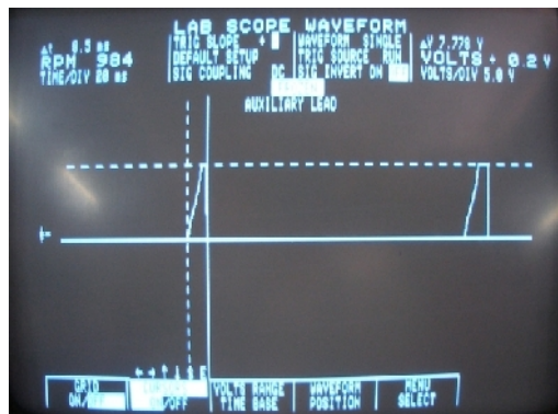
Hình 3.23 Màn Hình hi n th th i gian t ng tr ng và c ng dòng s c p
