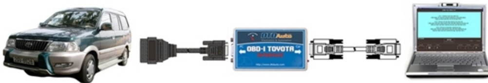
Hình 4.3 Sơ đồ kết nối máy quét mã laser OBD và xe
