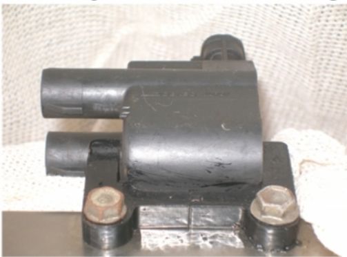
Hình 3.3 Bobine ôi động cơ Toyota 5S-FE và vị trí lắp đặt bobine ôi trên động cơ thử nghiệm
