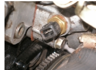
Hình 3.7 Cam bi n nhiệt nạp làm mát động cơ Toyota và vị trí lắp đặt cam bi n - Lắp đặt cam bi n nạp suất nạp vào động cơ .
