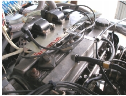
Hình 3.13 Động cơ thử nghiệm với hình ảnh lắp ráp bobine ô tô
