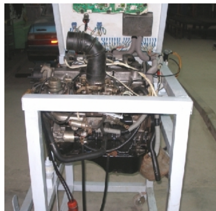
Hình 3.15 Động cơ thử nghiệm với hình ảnh lắp ráp bobine trên
