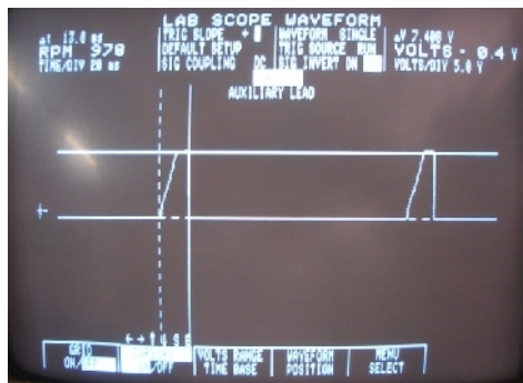
Hình 3.20 Màn Hình hiển thị thời gian tắt dòng và dòng sơ cấp
