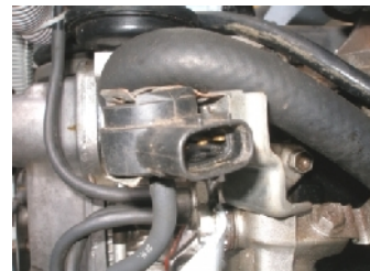
Hình 3.8 Cam bi n MAP động cơ Toyota và vị trí lắp đặt cam bi n
