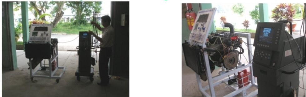
Hình 3.16a Kết nối thí nghiệm động cơ ảnh lái với động cơ Toyota 5A-F
