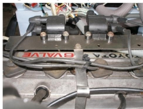
Hình 3.3 Bobine ôi động cơ Toyota 5S-FE và vị trí lắp đặt bobine ôi trên động cơ thử nghiệm
