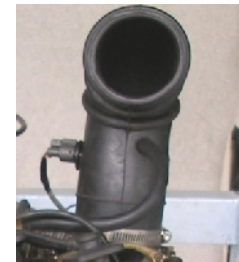
Hình 3.6 Cam bi n nhiệt khí nạp động cơ Toyota và vị trí lắp đặt cam bi n - Gia công lắp đặt cam bi n nhiệt nạp làm mát trên động cơ và lắp đặt cam bi n nhiệt nạp làm mát vào động cơ .
