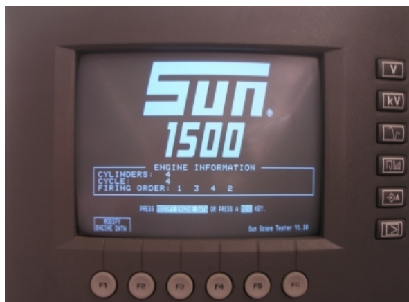
Hình 3.16a Kết nối thí nghiệm động cơ ảnh lái với động cơ Toyota 5A-F
