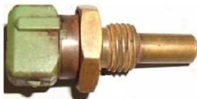
Hình 3.7 Cam bi n nhiệt nạp làm mát động cơ Toyota và vị trí lắp đặt cam bi n - Lắp đặt cam bi n nạp suất nạp vào động cơ .
