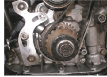
Hình 3.4 Vị trí lắp đặt bánh răng cam bi n và cam bi n vị trí trục khuỷu động cơ Toyota - Gia công và lắp đặt cam bi n vị trí cánh bơm ga vào buồng hòa khí động cơ .
