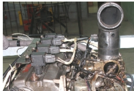
Hình 3.14 Bobine trên động cơ Mitsubishi và vị trí lắp đặt bobine trên động cơ thử nghiệm
