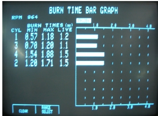
Hình 3.21 Xung ánh la th c p, b n i n áp ánh la và th i gian cháy th c p i n áp th c p là U_{dl} = 8KV và th i gian t n t i tia l a cao áp là t = 1,5ms
